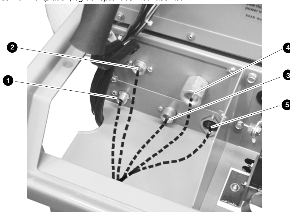
Fig. 8. Hvis der skal benyttes mekanisk drift med skærmet lige brænder, fjernes gummitætningen, kraven føres ind i frontpladen, og der spændes med låsemøtrik.
