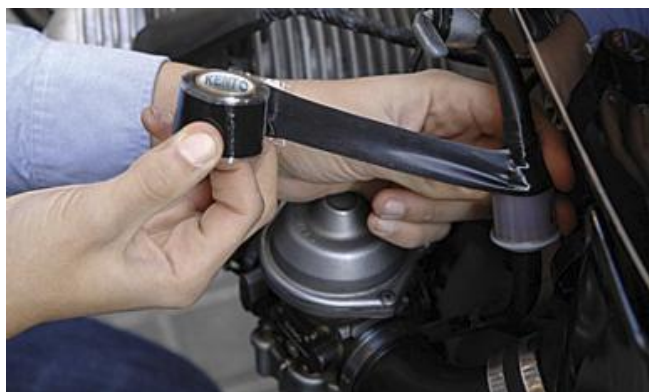
Reparation Banzinslange ved filter
